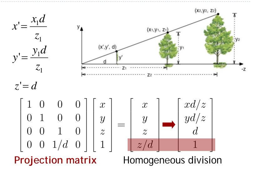
$$\begin{bmatrix} 1 & 0 & 0 & 0 \\ 0 & 1 & 0 & 0 \\ 0 & 0 & 1 & 0 \\ 0 & 0 & 1/d & 0 \end{bmatrix} \begin{bmatrix} x \\ y \\ z \\ 1 \end{bmatrix} = \begin{bmatrix} x \\ y \\ z \\ z/d \end{bmatrix} = \begin{bmatrix} xd/z \\ yd/z \\ d \\ 1 \end{bmatrix}$$
